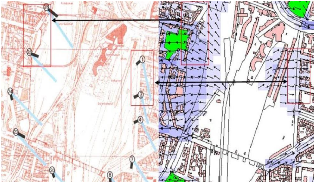
그림 27. 왼쪽 도면은 글라이스드라이엑의 측정결과이며 오른쪽 그림은 이에 근거하여 산출한 FITNAH 시뮬레이션 결과를 부분적으로 확대한 것이다. 왼쪽의 각 측정지점의 하늘 색 선은 바람이 불어오는 방향을 나타낸다. 오른쪽 시뮬레이션의 화살표는 공기 흐름의 방향을 나타낸다.
