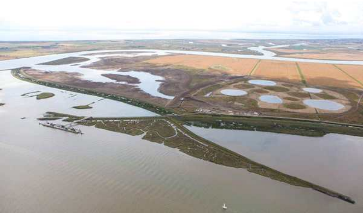
그림 30. Wallasea Island Wildcoast. 엔지니어링 기술을 적용하여 범람지와 버퍼존을 만들어 높은 파도를 흡수, 홍수위험을 방지하게 되었다. © wallasea-island-wild-coast-project
