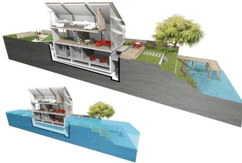
그림 14. 정상 수위에서는 일반 주택과 다름이 없으나 수위가 높아지면 부유하도록 설계되어 있음. 사진: Baca Architects, London.
