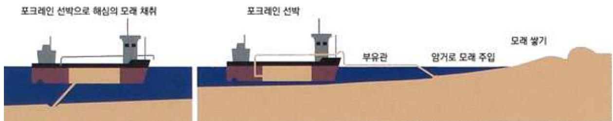
그림 6. 특수 포크레인 선박으로 해심에서 바닷물과 함께 모래를 채취한 뒤 이를 모래사장에 묻어둔 암거를 통해 주입시키는 방법. 사구가 쌓일 때까지 주입하며 포크레인으로 일차 분산시킨다. 후에 파도에 의해 자연스럽게 분산된다. 모래사장의 규모를 일정하게 유지하는 방법. 그래픽: Hajotthu CC BY-SA 3.0, modified by Thirdspace Berlin.
