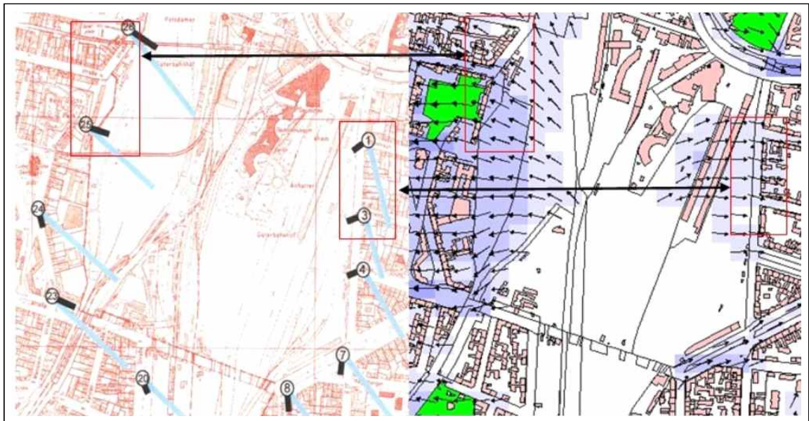
그림 22 왼쪽 도면은 글라이스드라이역의 측정결과를 나타내며 오른쪽 그림은 이에 근거하여 산출한 FITNAH 시뮬레이션 결과를 부분적으로 확대한 것이다. 왼쪽의 각 측정지점의 하늘 색 선은 바람이 불어오는 방향을 나타낸다. 오른쪽 시뮬레이션의 화살표는 공기 흐름의 방향을 나타낸다.
